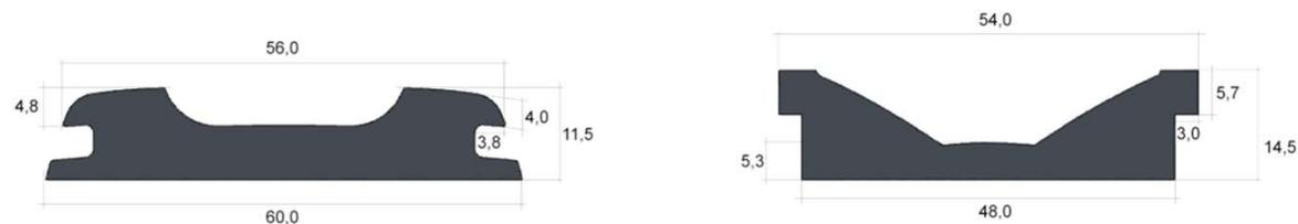
Профиль платформы POWER RAIL, на которую устанавливаются крепления, низок и широк – он лучше передает энергию от креплений непосредственно к кантам лыжи, более интегрирован в лыжу, лучше усаживает крепления на лыжи. При установке - крепления устанавливаются легко, быстро, надежно. Отсутствие зазоров обеспечивает отличное удержание, торсионную жесткость конструкции, устраняются все возможные люфты системы.
